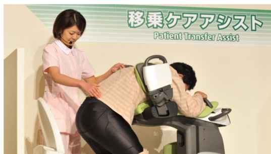
Sieht aus wie ein etwas plumper, überdimensionierter Kinderroller, kann aber ein wertvoller Helfer für Pflegebedürftige sein: Der sogenannte Patient Transfer Assist , ein neu entwickelter Roboter, hilft beim Toilettengang. (© AFP)
